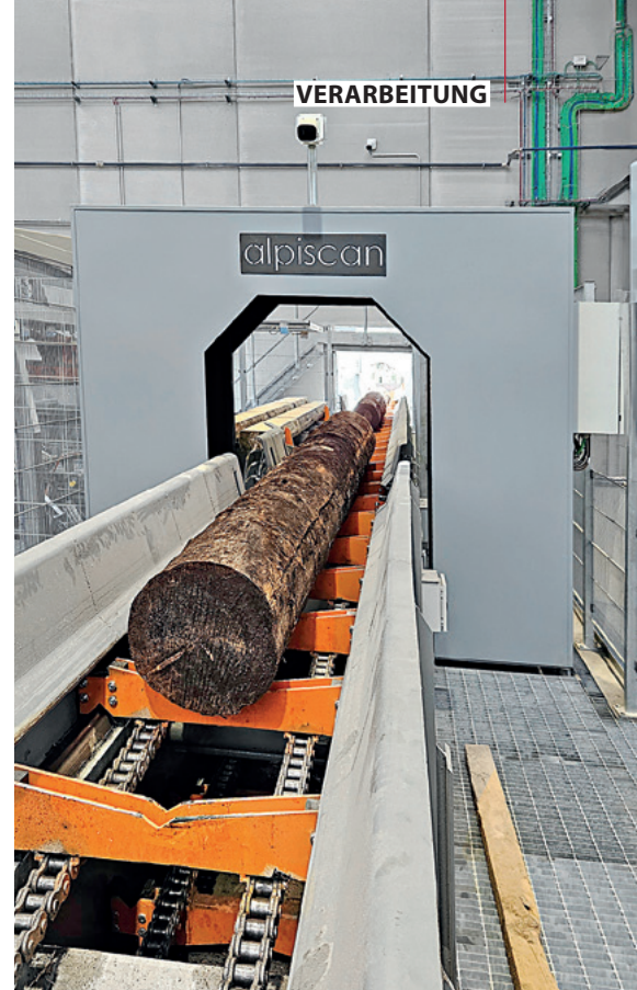
Dank der Snapshot-Scannerlösung von Alpiscan werden die Messungen weder von dunklen Stammoberflächen, noch von einer hellen Umgebung oder von Drehbewegungen des Stammes verfälscht
