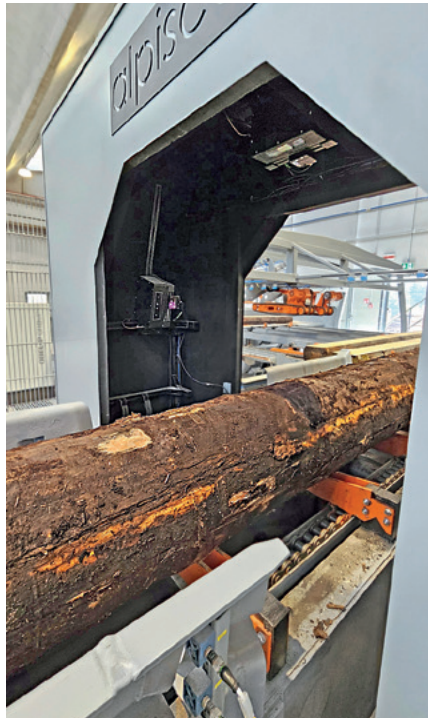
Dank der Snapshot-Scannerlösung von Alpiscan werden die Messungen weder von dunklen Stammoberflächen, noch von einer hellen Umgebung oder von Drehbewegungen des Stammes verfälscht
