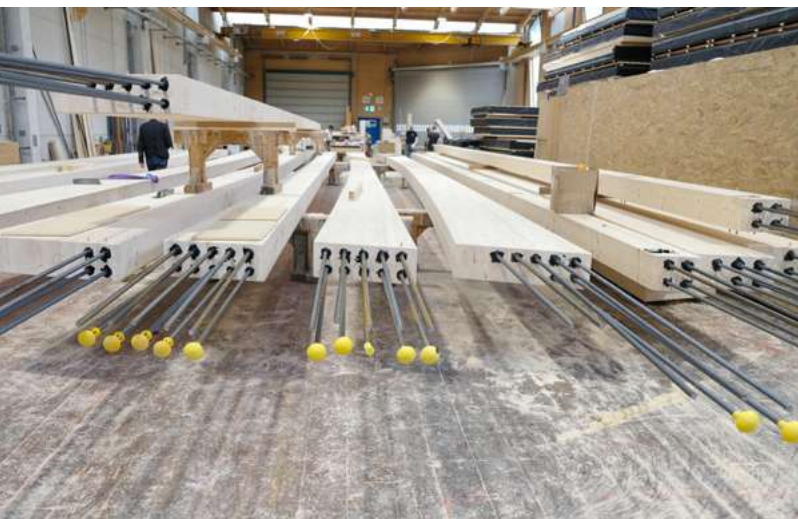
Knifflige Sonderprojekte, wie diese blockverleimte Brücke, sind die Spezialität von Huter & Söhne
