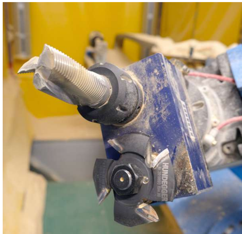
Der Multi-Bearbeitungskopf von Hundegger nimmt einen Fingerfräser und einen Harzgallenfräser auf, wodurch sich Huter zahlreiche Werkzeugwechsel spart
